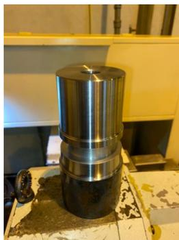
Предварительная механическая обработка заготовка. На данном этапе, на токарном станке с числовым программным управлением (ЧПУ) снимается часть металла, сверлятся отверстия не высокой точности. Твердость заготовки не высока, по этой причине выгодно обработать как можно больше поверхностей детали невысокой точности, так как на это тратится меньше обрабатывающего режущего инструмента, и обработка проводится быстрее, чем на детали после термообработки, где её твердость и прочность становится выше.
